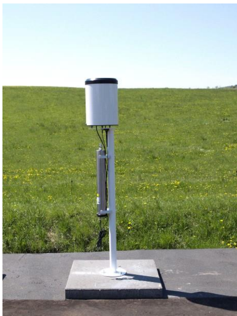
Obr. č. 16 Správně provedená instalace srážkoměru se zachytnou plochou 200 cm 2
