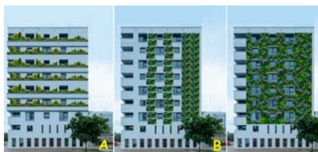
Obrázek 65: Schematické znázornění systémů vertikálních zahrad
